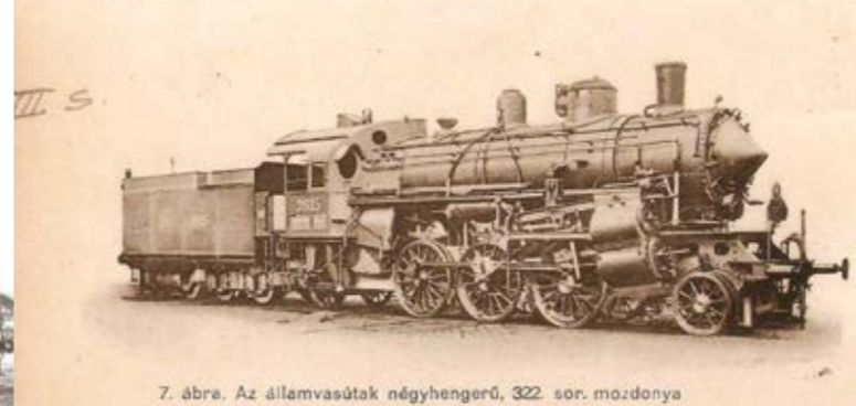
7. ábra. Az államvasutak négyhengerű, 322. sor. mozdonya
